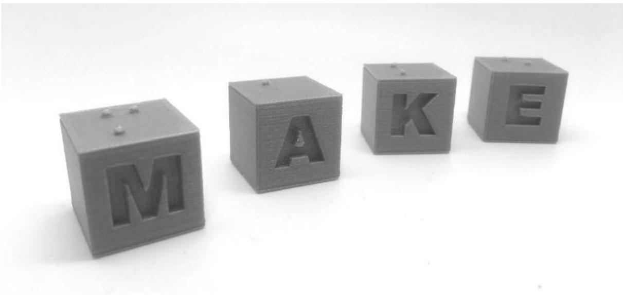
Recomendamos que você use filamento PLA, uma altura de camada entre 0,1-0,2mm e uma jangada dependendo das capacidades de sua impressora 3D. Se você precisar de aconselhamento adicional, entre em contato com [hello@weareprintlab.com](mailto:hello@weareprintlab.com).
